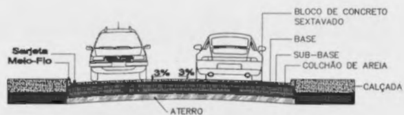
Seção Tipo - Pavimento
