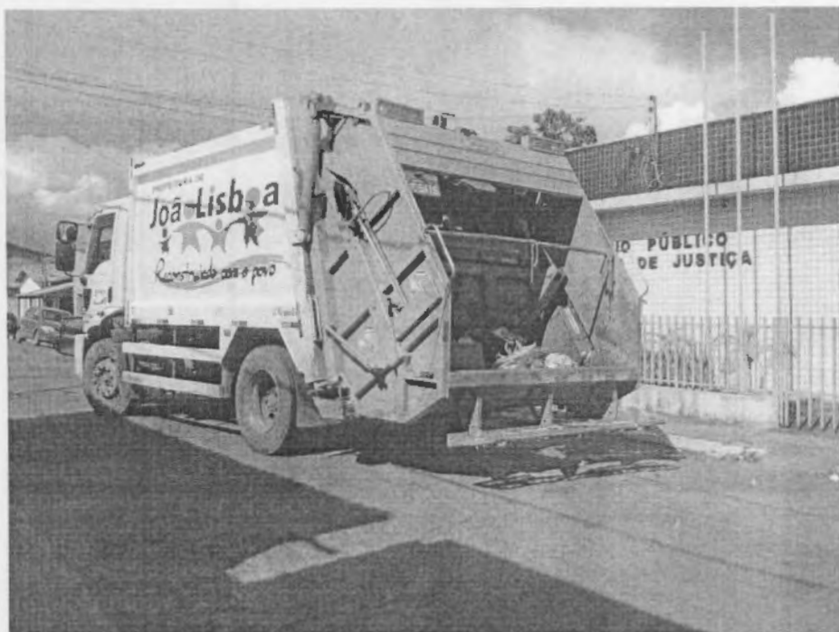
Figura 4 - Caminhão Compactador utilizado para o transporte dos resíduos urbanos. Fonte: Pesquisa Direta, 2014.
