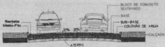
Seção Tipo - Pavimento
