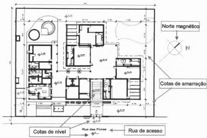
Figura 41- Planta de locação creche tipo C
